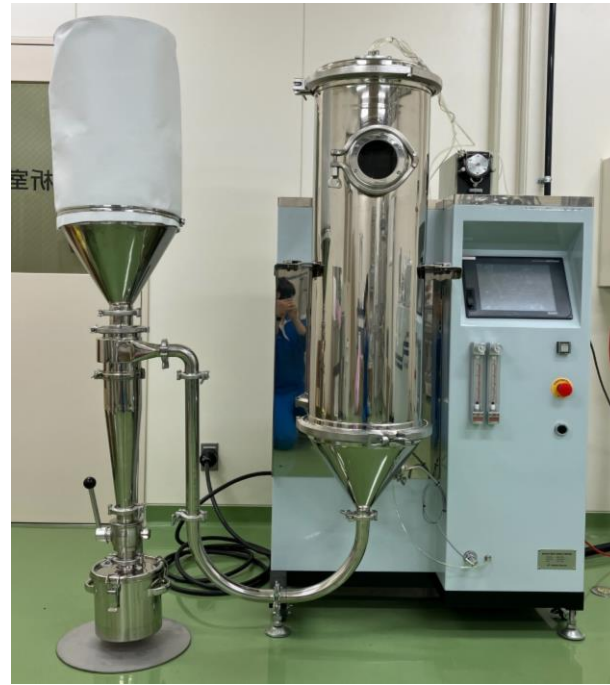
噴霧乾燥設備
